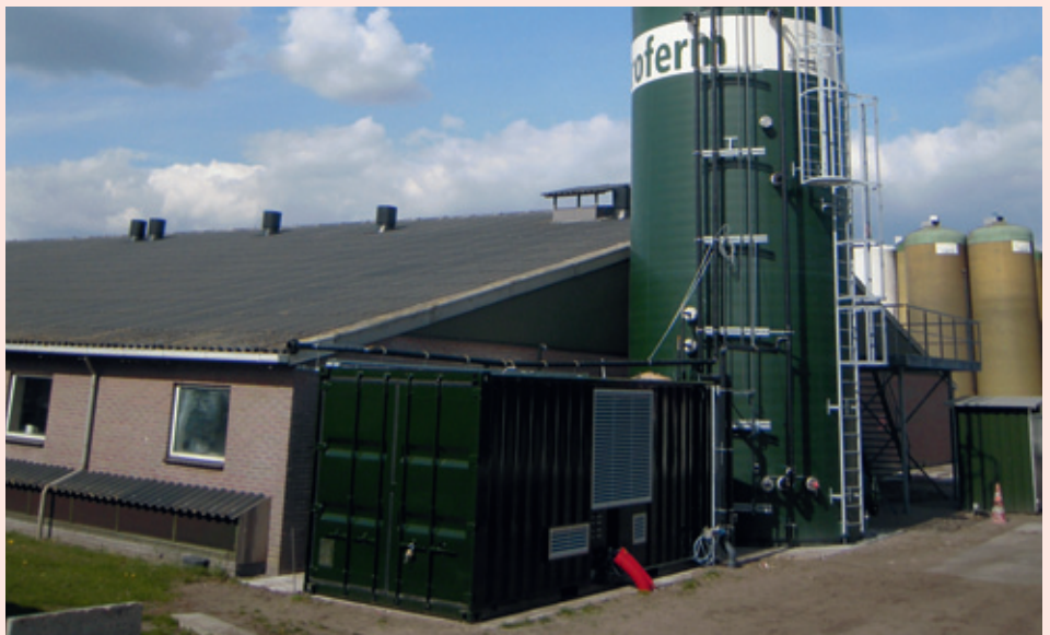
Mobile Mini-Biogasanlagen zur Verbrennung von Gülle sind eines der innovativen Forschungsvorhaben des VIC.
