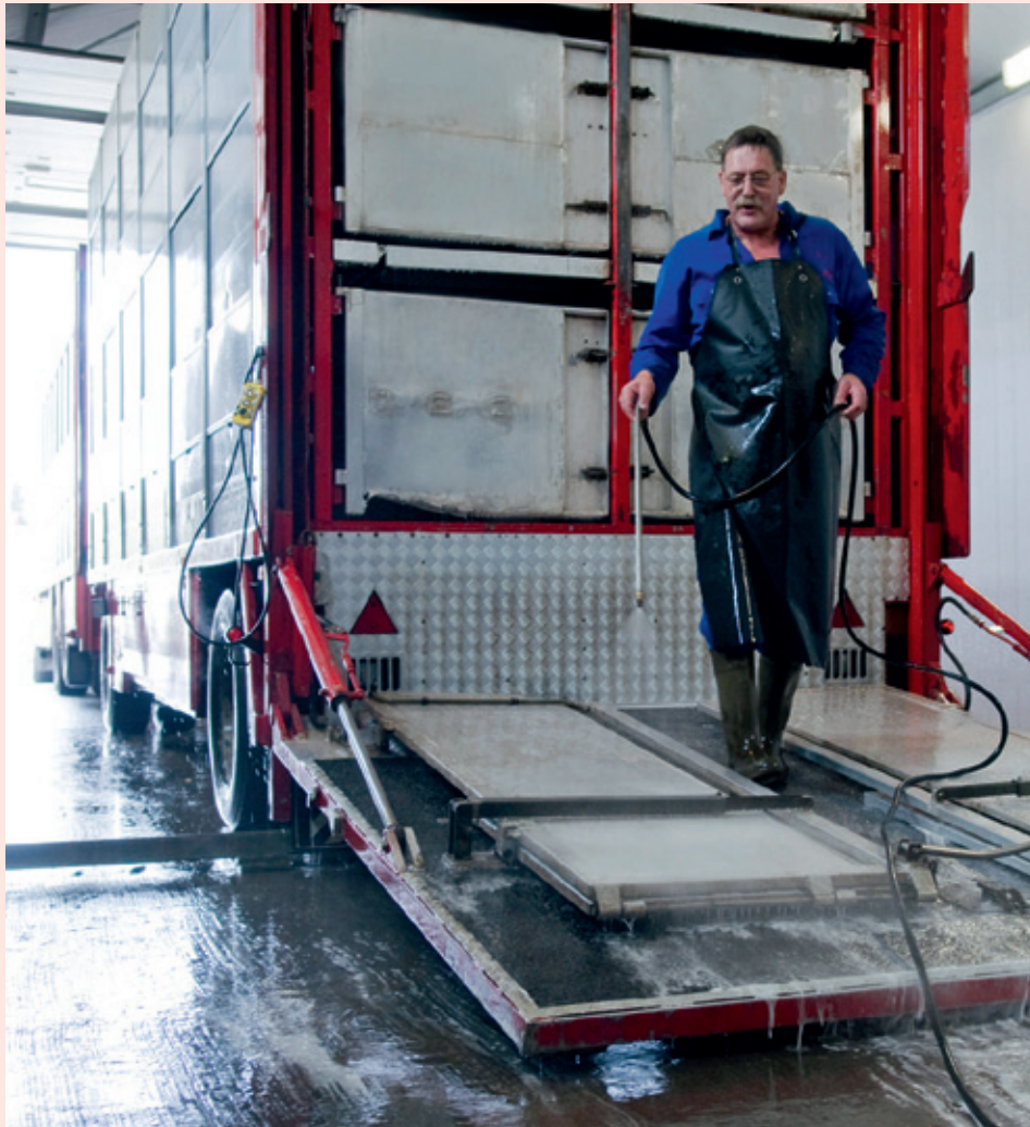
Mit mobilen Reinigungssystemen können Fahrzeuge für den Tiertransport unabhängig von den örtlichen Gegebenheiten gereinigt werden.
